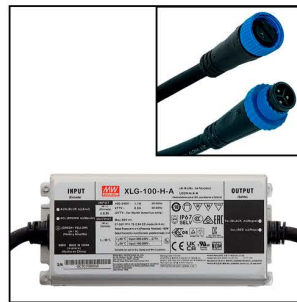
FUENTE DE ENERGÍA input 100-240 V ac output 48 V dc conectores estancos
